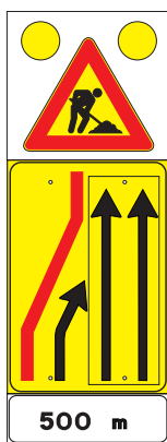
Fig. 399/a presegnale di cantiere mobile
