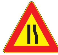
Fig. 386 - 3860 strettoia asimmetrica a destra
