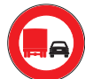
Fig. 52* - 0520 divieto di sorpasso per veicoli di massa a pieno carico sup. 3,5 ton.
