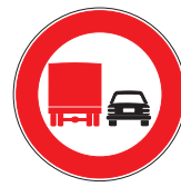
Fig. 52* - 0520 divieto di sorpasso per veicoli di massa a pieno carico sup. 3,5 ton.
